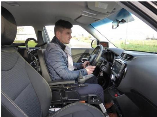
Figure IV.a : Conduite embarquée avec fauteuil roulant électrique
