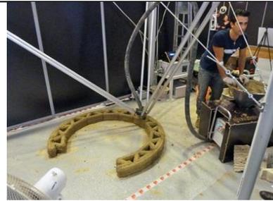
Figure 4 : Imprimante 3D de grande taille béton.
