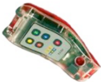
Le B.A.Bar : un appareil à synthèse vocale
