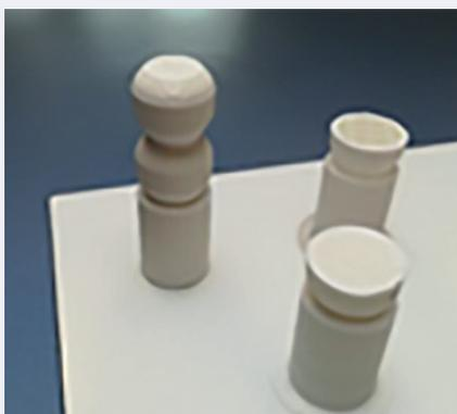
Le ratio poids/solidité peut être contrôlé facilement en fonction du taux de remplissage et de l'utilisation de différents matériaux. Il est donc important de bien identifier la solidité souhaitée afin d'alléger ou non le poids des aides techniques.
